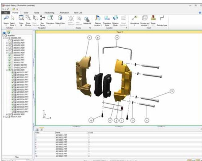
Utilizzo di strutture di prodotto CAD per generare dinamicamente elenchi parti con callout e mantenere l'associatività con il modello di progettazione tecnica per automatizzare le modifiche quando si apportano modifiche di progettazione.
